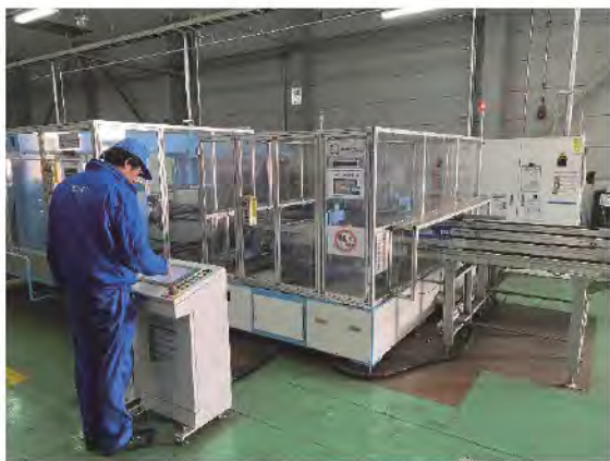
写真4 太陽光パネル再資源化ライン
