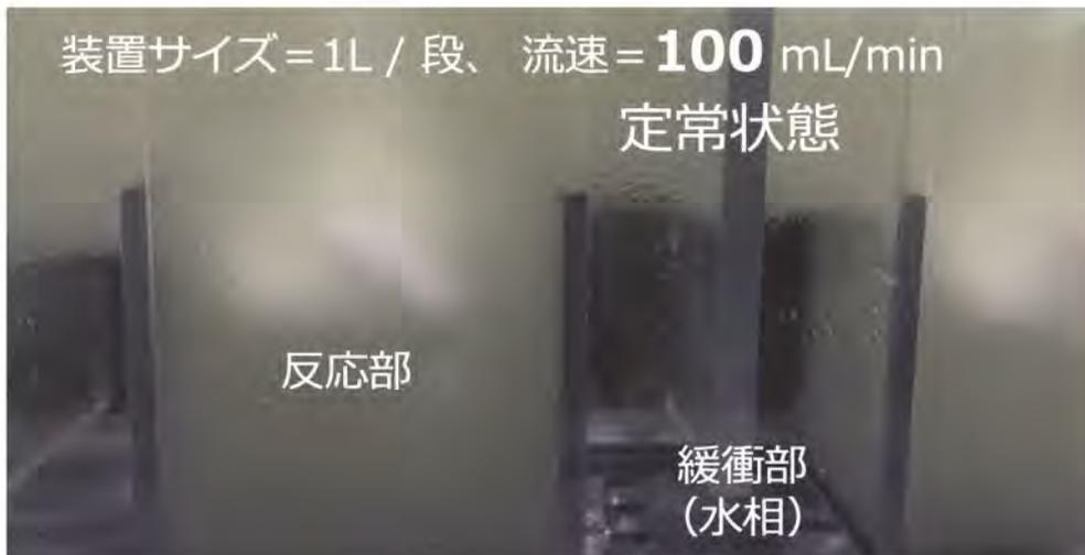
図 7 機械攪拌式の多段エマルションフローでの相分離
