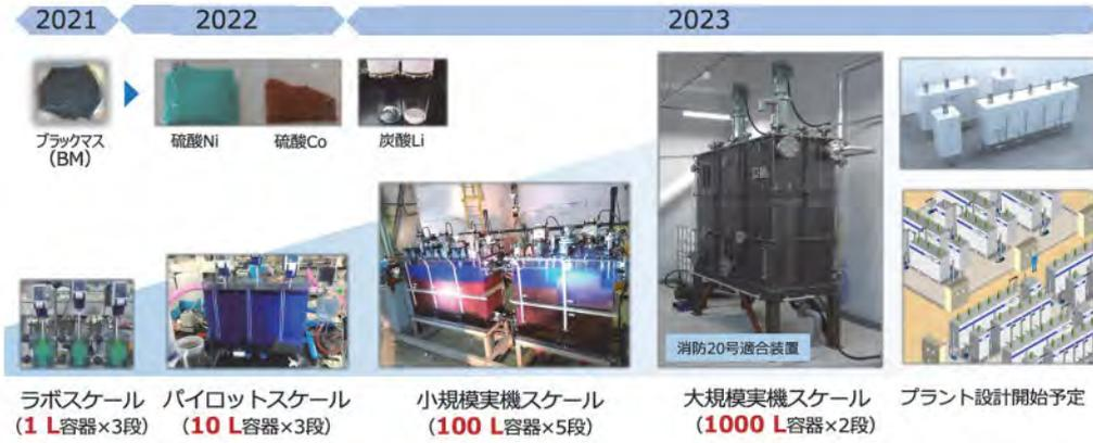
図 8 機械攪拌式エマルジョンフロー（多段）の実機へのスケールアップ
