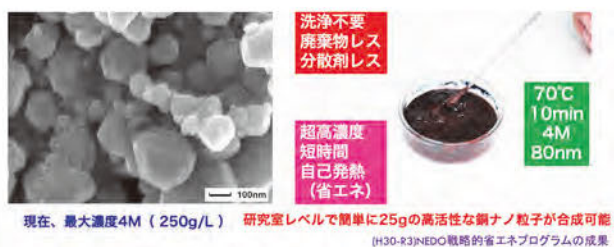
Fig. 10 酸化銅+プロパノール+ヒドラジン+自己発熱還元 = 分散剤フリー銅ナノ粒子の超高濃度短時間合成
