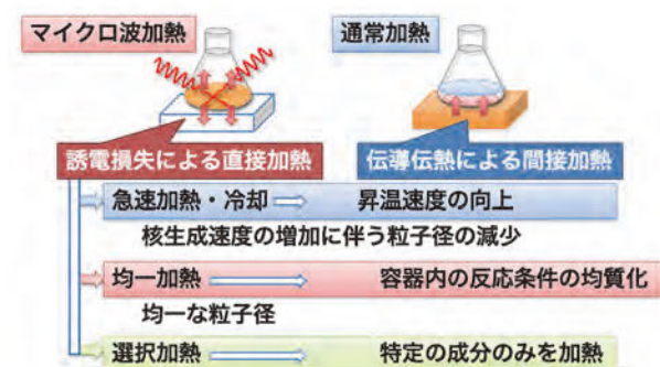
Fig. 6 マイクロ波加熱の特徴と通常加熱との違い
