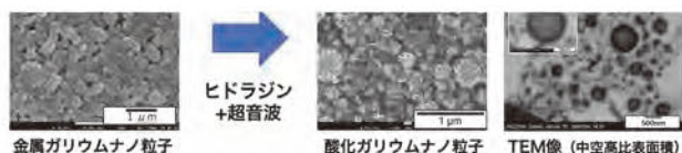
Fig.13 金属ガリウム+アルコール+ヒドラジン+超音波 = 分散剤フリー高比表面積酸化ガリウムナノ粒子の室温合成
